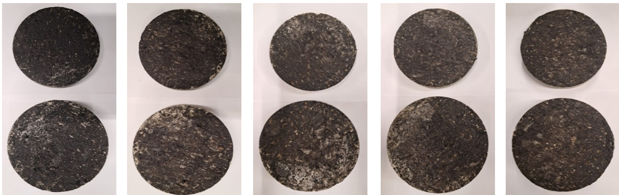
Abbildung 2: Scherflächen nach dem Abscherversuch (von links nach rechts: Variante 1 bis 5)
