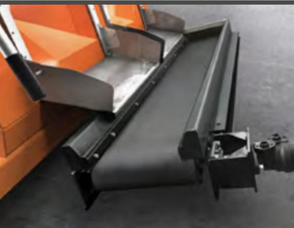
Hydraulisches Anbauförderband für Kipperaufbauten und Thermocontainer Asphalt.
